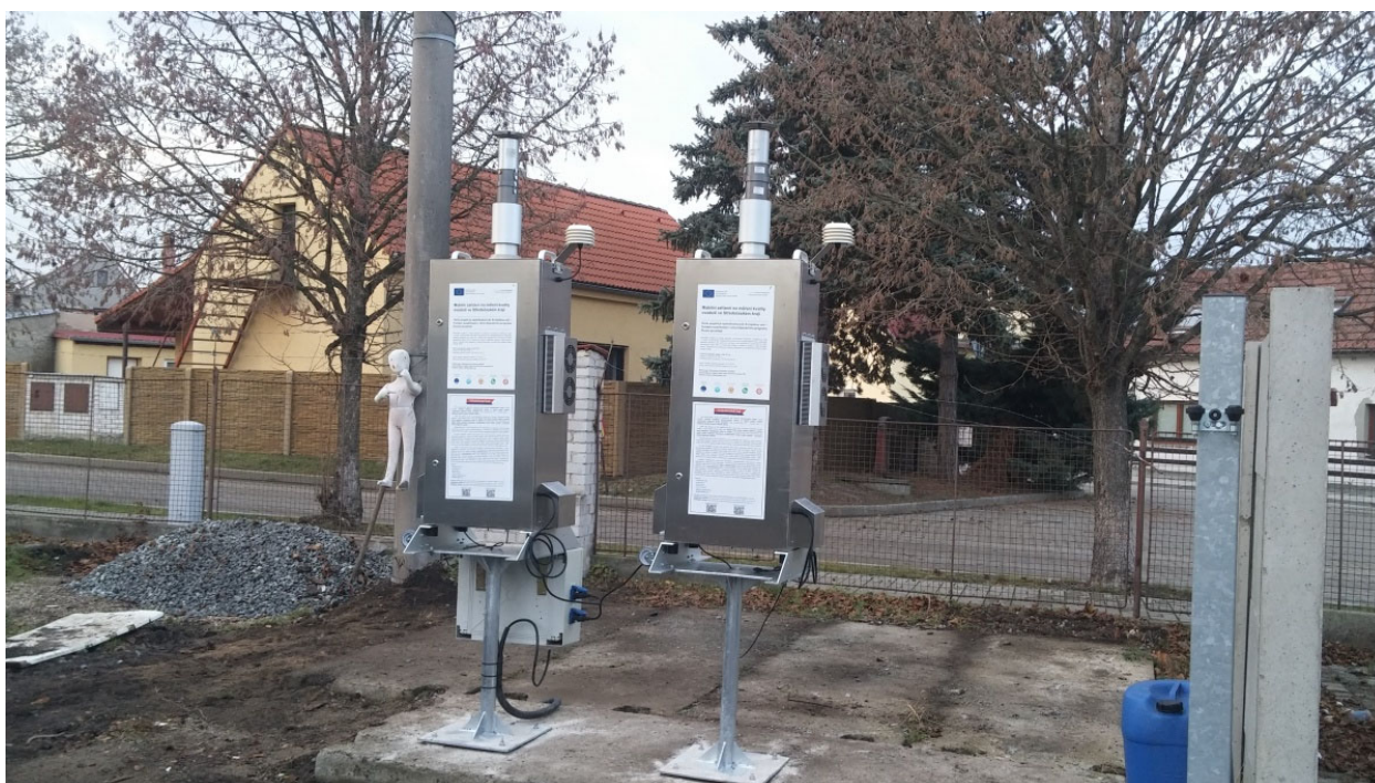
Obr. 2 Vzorkovače imisní stanice Úžice, dva přístroje Sven Leckel
