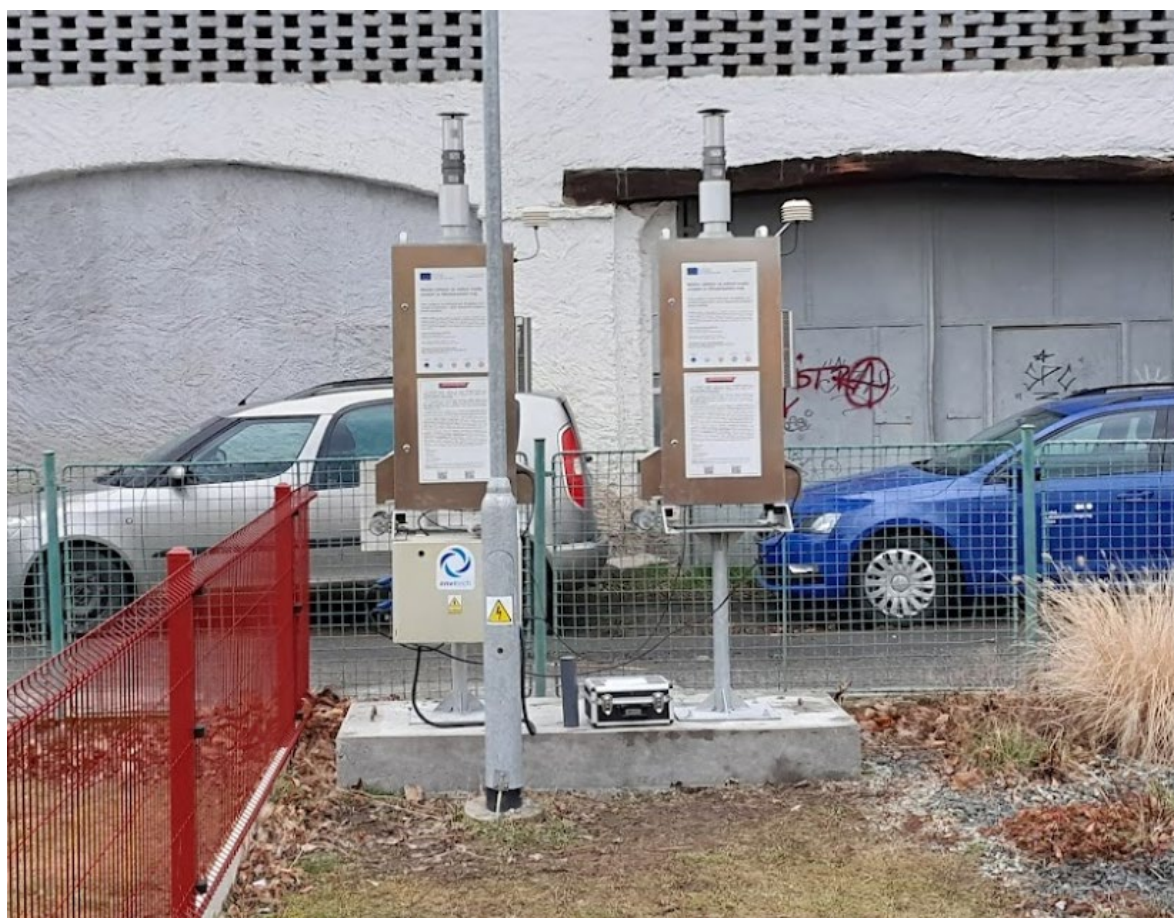
Obr. 2 Vzorkovače imisní stanice Pečky, dva přístroje Sven Leckel
