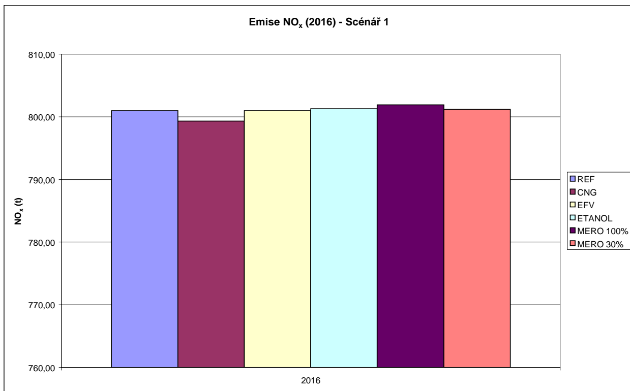
Graf 14 Odhad emisí NO x vozidel veřejné hromadné dopravy v roce 2016 dle scénáře 1
